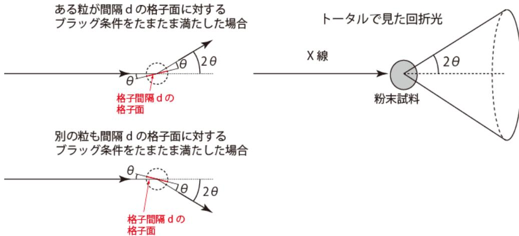
先ほど述べたように、結晶の場合はいろいろな  $d$  を持つ周期構造があるため、それぞれの  $d$  に応じて、複数の円錐状の回折光が生じている。それらはスクリーン上では同心円状のパターンとなる。(デバイー・シェラー環)。また、X線検出機をスクリーンの中心にあたる位置から徐々に動かしていけば、検出器がデバイー・シェラー環を横切るときに回折X線が検出される。このようにして、Intensity vs.  $2\theta$  のスペクトルを得ることができ、そのピーク位置の  $\theta$  の値と、ブラッグ条件を用いれば結晶の周期構造  $d$  を決めることができる。
