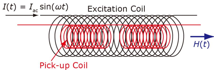
このようにして物質の磁化率（に比例する起電力）を測る方法を
