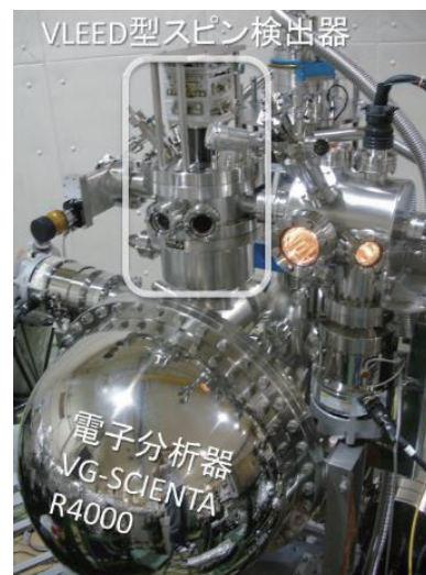
図 1：世界最高効率の VLEED 型スピン分解光電子分光装置
