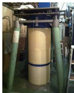
NMR 測定が行われている二段核断熱消磁冷凍機本体。ノイズとの戦いの日々でした。
