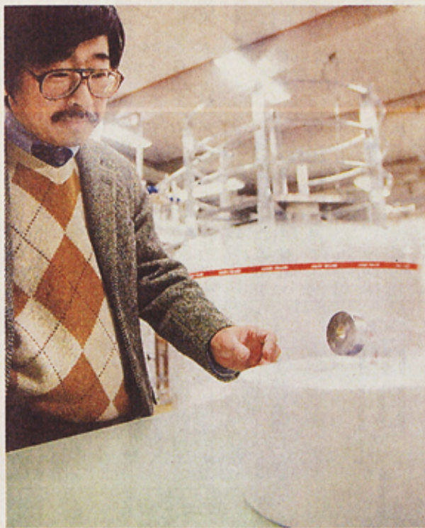
液体窒素で冷却し超電導で浮き上がる磁石を見つめる寺嶋孝仁教授(京都大宇治キャンパス)
