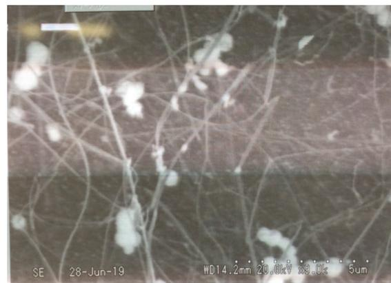
[図1](#): トポロジカル物質である  $\text{Cd}_3\text{As}_2$  のナノワイヤ試料。塊状の生成物に加えて、ナノワイヤ試料も観測されている。直径は100nm程度で長さは数10 $\mu\text{m}$ 。
