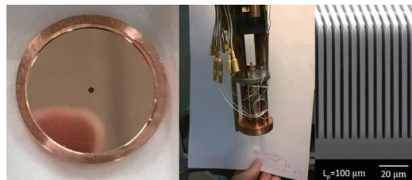
(左) 円盤容器の片側。1 $\ \mu\text{m}$ の段差がかすかに視認できる。
