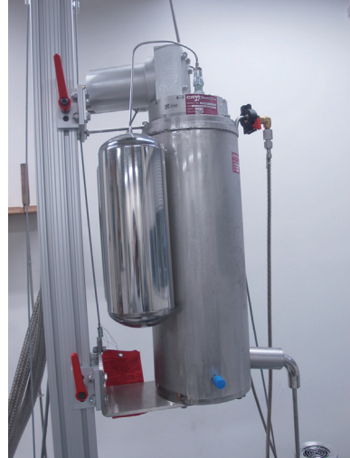
写真1: Cryomech社製再凝縮装置の外観。右下に見えているチューブをクライオスタットに挿して運用する。
