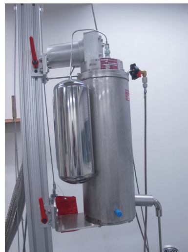
写真1: Cryomech社製再凝縮装置の外観。右下に見えているチューブをクライオスタットに挿して運用する。
